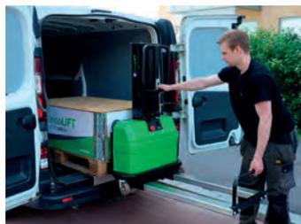
2. Palette absetzen, den Schlitten nach hinten ziehen und den InnoLIFT hochfahren.
