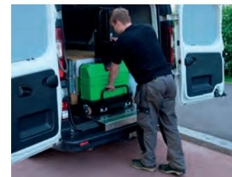
4. Palette mit dem InnoLIFT ins Fahrzeug schieben und absetzen.
