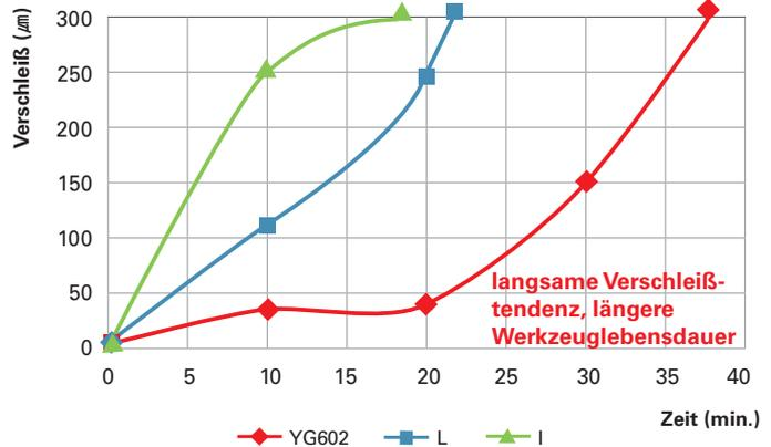
※ Verschleißwert nach Test : 300µm (Freiflächenverschleiß)
