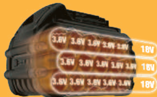
Kombinierte Reihen- und Parallelschaltung im 18,0 Volt-Betrieb
